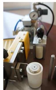
4. Клеевой бак уменьшенного объема, позволяющий быстрее выходить на рабочую температуру, сохранять клеящие свойства и экономнее расходовать клей расплав.
